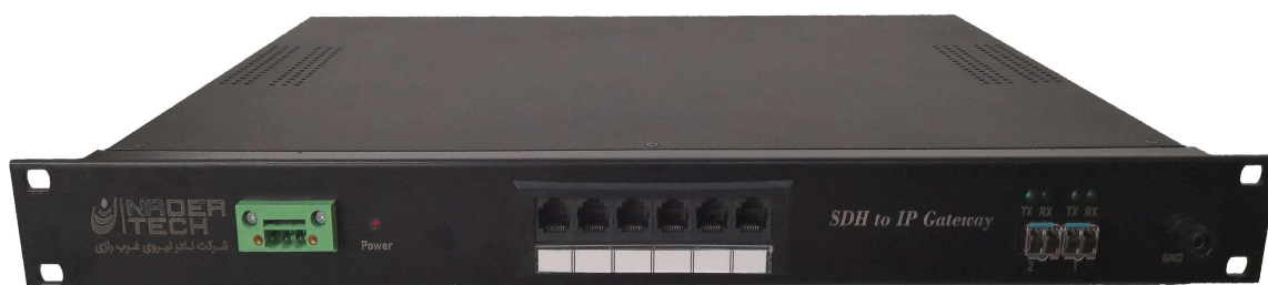
شکل ۱: شمای ظاهری دستگاه مبدل رادیو دیجیتال به رادیو IP
